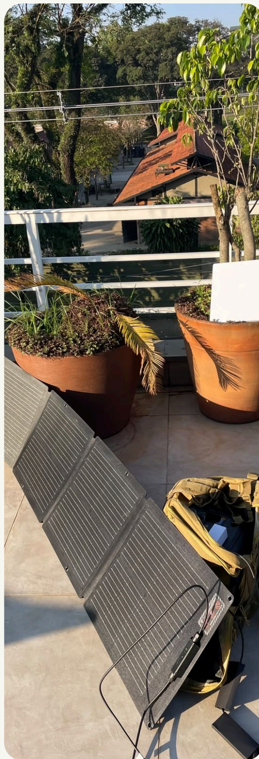
UPEC-750 em operação: painel solar dobrável conectado à mochila e antena Starlink posicionada.
